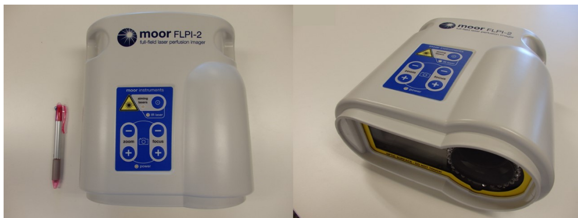
図 3-2 LCSI. 本研究では moor FLPI-2 (Moor instruments, UK) を使用した。本機器は 785nm のクラス I の近赤外線レーザを使用している。580 × 752 ピクセルの CCD カメラで標的部位を撮影する。
