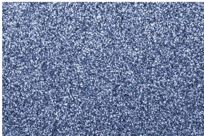
図 3-1 スペックルパターン. レーザ光を生体組織のような散乱粒子の集合に照射すると、レーザ散乱光の干渉によりスペックルパターンが生じる。散乱粒子の移動によりスペックルパターンは時間的に変化する。
