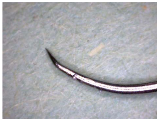
Fig. 5.10 縫合速度試験 後のサンプル縫合針の先端 拡大図
