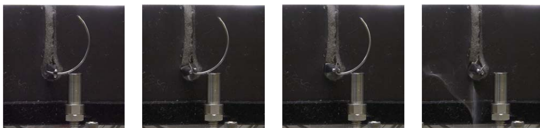
Fig. 6.3 縫合針折れが発生した時の画像
