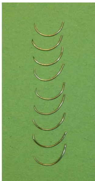
Fig. 5.9 縫合速度試験後の サンプル縫合針の先端
