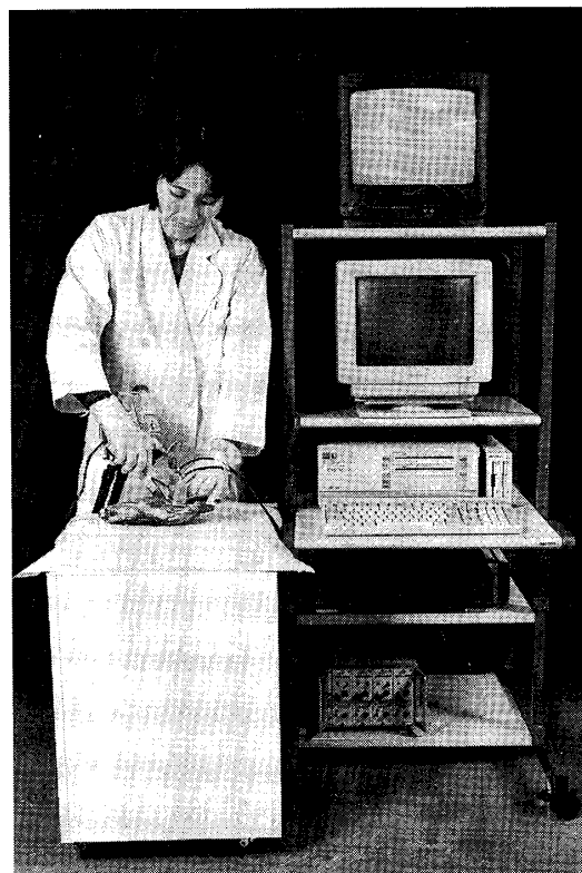
図5 皮膚切開時の力学的測定システムの全景 切開状況のモニタ(上)とセンサの出力モニタ(中)と コンピュータ(下)を示す。
